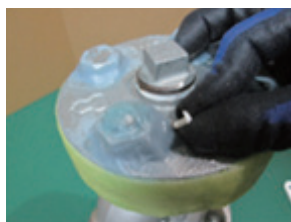
5. ホースを切り縮め、瞬間接着剤で封止ピンを設置し、仮修正完了。 発泡液で漏れを確認。
