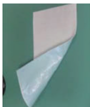
紫外線硬化型FRPシート (UV-FRPシート)
