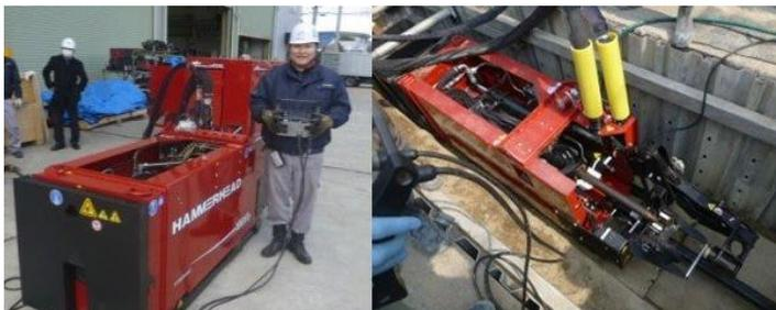
STREAM 工法 パワーパックと引込装置
