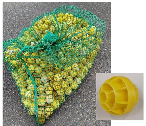
PE 管を再資源化した仮埋め戻し材
