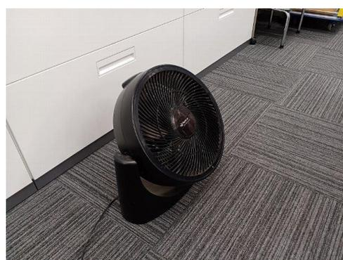
サーキュレータによる室内上下温度差の解消
